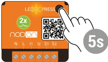
**1** Appuyez plus de 5 secondes sur le bouton du module. La LED scintille orange.
