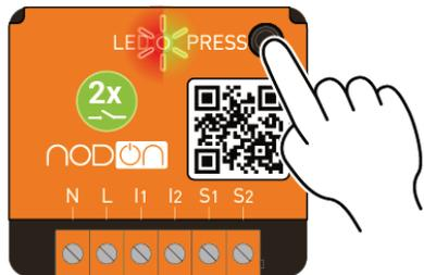
**2** Appuyez à nouveau sur le bouton (impulsion brève) pour valider la réinitialisation. Si la réinitialisation se déroule correctement, la LED clignote alternativement en rouge et en vert. Recommencez si nécessaire.
